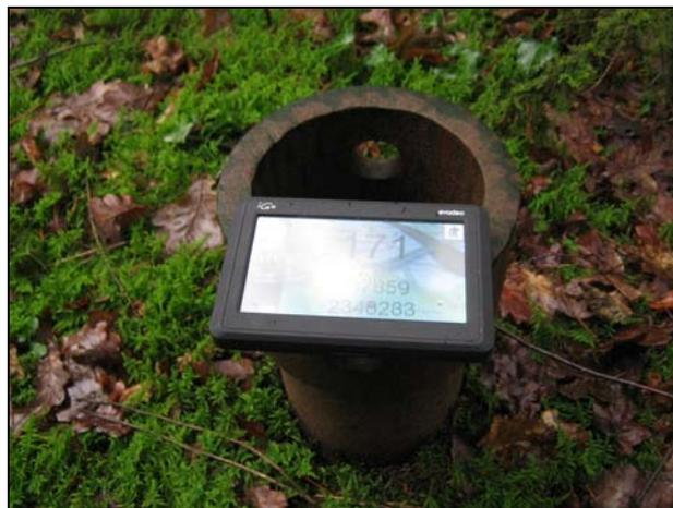
Forage technique (diamètre : 150 mm) situé au NW du site (dans le bois)
